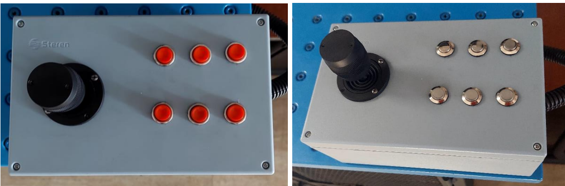
Figura 38. Reemplazó de botones de plástico por botones metálicos.
