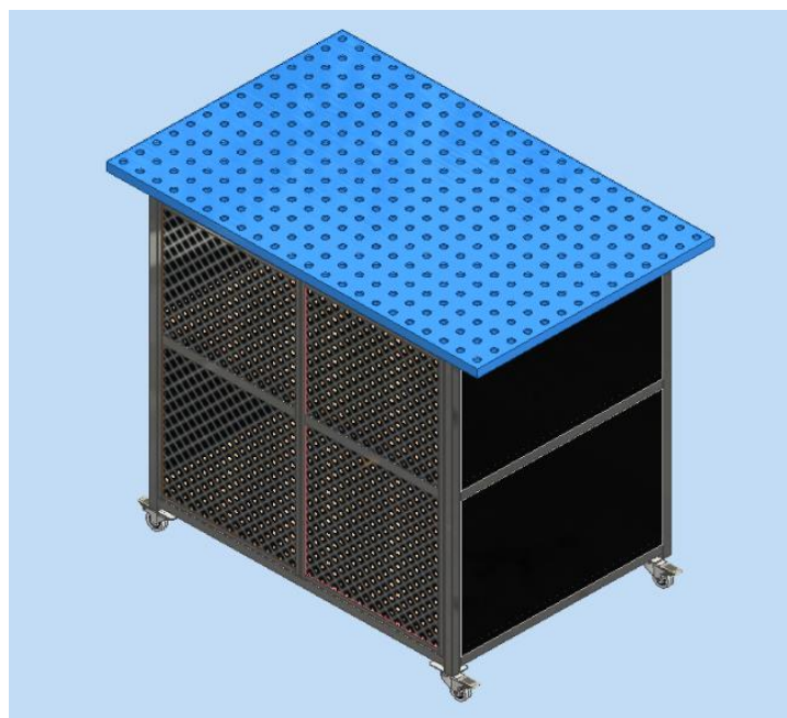
Figura 33. Base móvil diseñados en un CAD.
