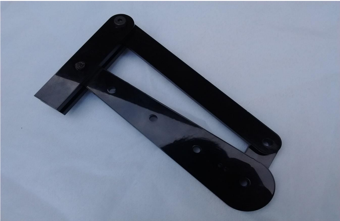
Fotografía 5. Eslabonamiento del segundo mecanismo (referencia, salida, acoplador y salida, iniciando en el eslabón de referencia en el sentido de las manecillas del reloj).
