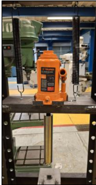
Figura 71. Ensamble del gato hidráulico [Imagen propia].
