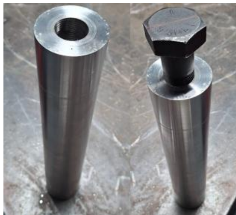
Figura 53. Barra de compactación fabricada [Imagen propia].
