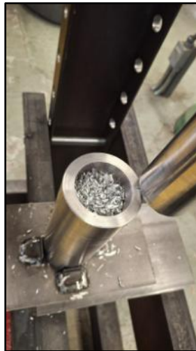
Figura 84. Llenado del molde de compactación con viruta de aluminio [Imagen propia].
