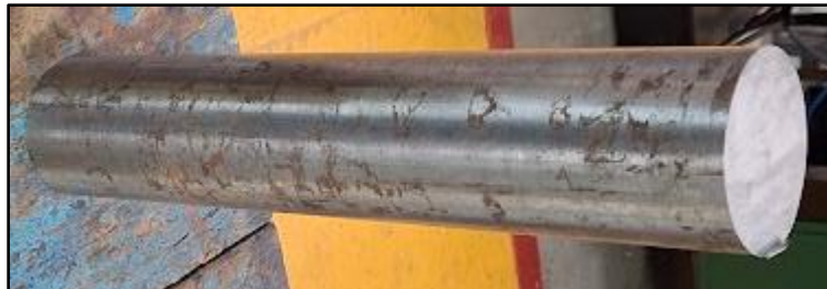
Figura 51. Materia prima para la barra de compactación [Imagen propia].
