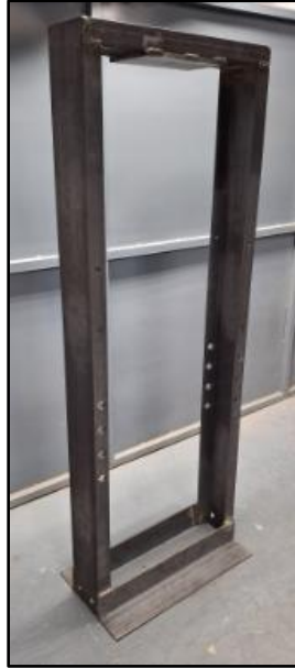
Figura 63. Estructura principal unida por soldadura [Imagen propia].
