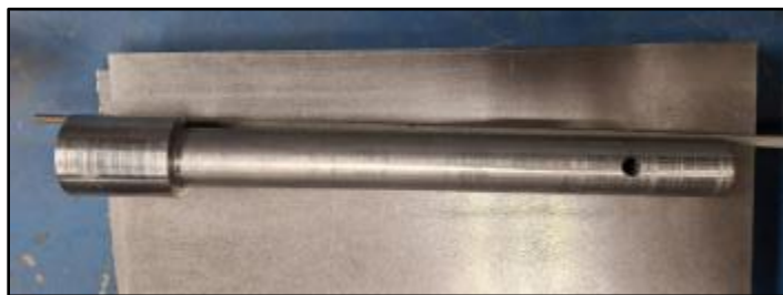
Figura 59. Perno fabricado [Imagen propia].
