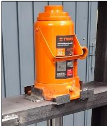
Figura 54. Fijación del actuador hidráulico [Imagen propia].
