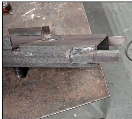
Figura 55. Guías para la base del actuador [Imagen propia].
