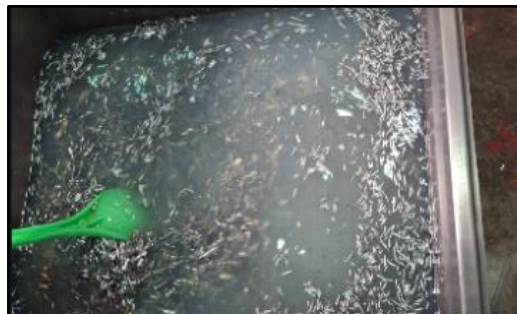
Figura 80. Agitación de la viruta dentro de la solución preparada [Imagen propia].
