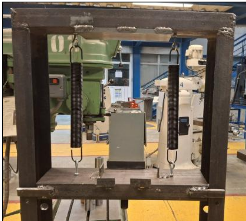
Figura 68. Ensamble de la base del actuador [Imagen propia].
