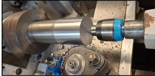
Figura 47. Eliminación de imperfecciones a la materia prima del molde de compactación [Imagen propia].
