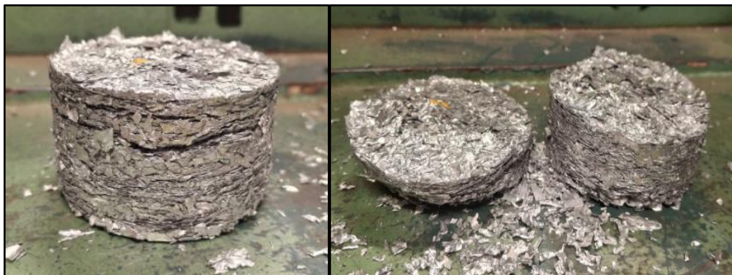
Figura 87. Brique de viruta obtenida de la prueba de compactación por partes [Imagen propia].
