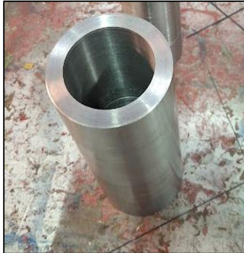
Figura 50. Molde de compactación fabricado [Imagen propia].
