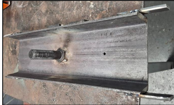
Figura 56. Tornillo de acoplamiento de la barra de compactación [Imagen propia].
