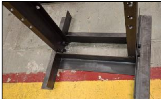
Figura 64. Ensamble de los soportes [Imagen propia].
