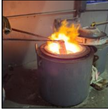
Figura 91. Lingote agregado al crisol [Imagen propia].
