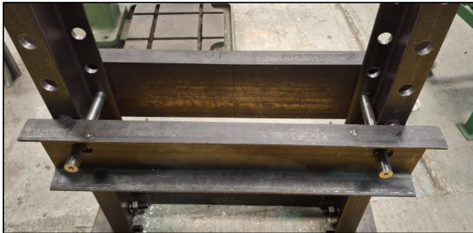
Figura 66. Ensamble de las bases de compactación [Imagen propia].
