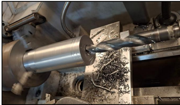
Figura 48. Perforación del molde con brocas [Imagen propia].
