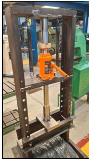
a) Mecanismo comprimiendo la viruta de aluminio
