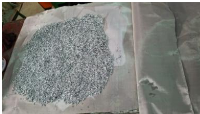
Figura 82. Viruta colocada en la rejilla para su secado [Imagen propia].
