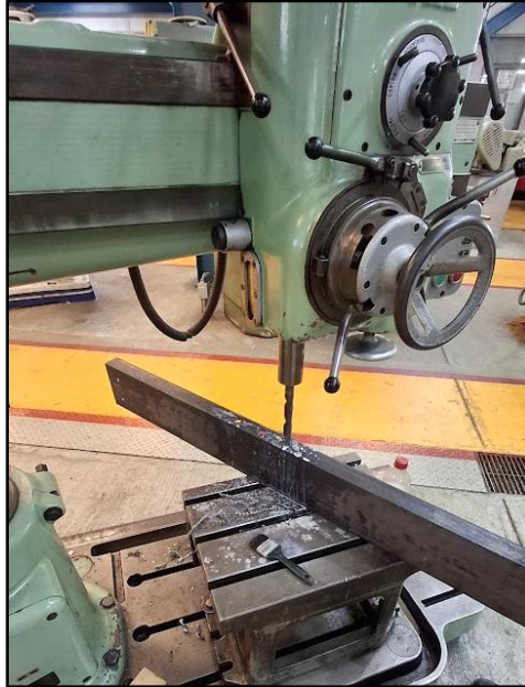
Figura 43. Perforación de las estructuras laterales [Imagen propia].
