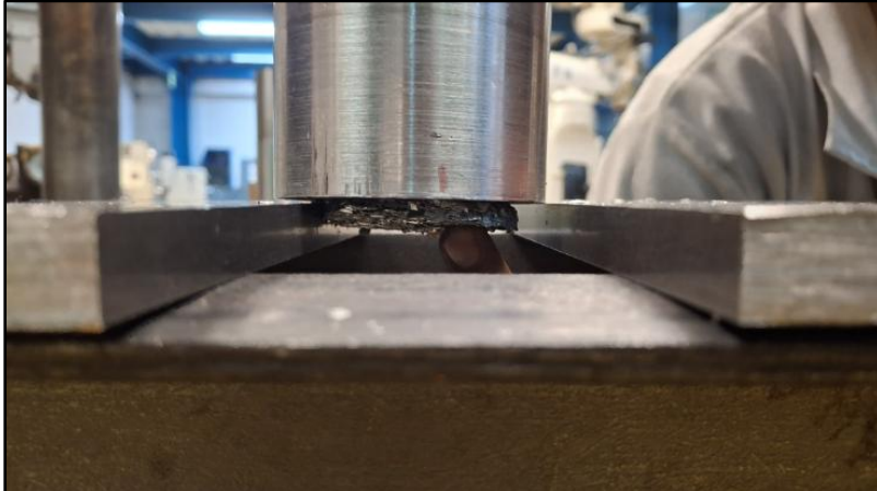
Figura 86. Extracción de la briqueta [Imagen propia].
