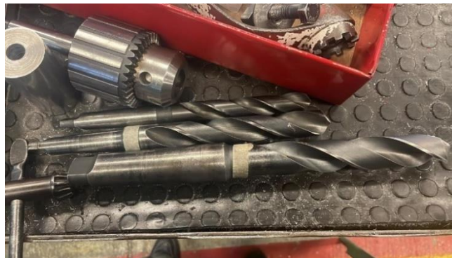
Figura 107. Brocas utilizadas para retirar la mayor cantidad de material de la barra durante el proceso de torneado.
