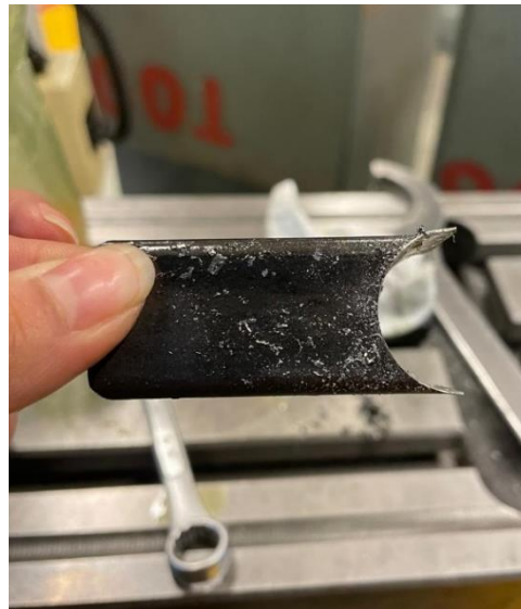
Figura 118. Corte realizado para embonaje correcto en el tubo ELC de la jaula.
