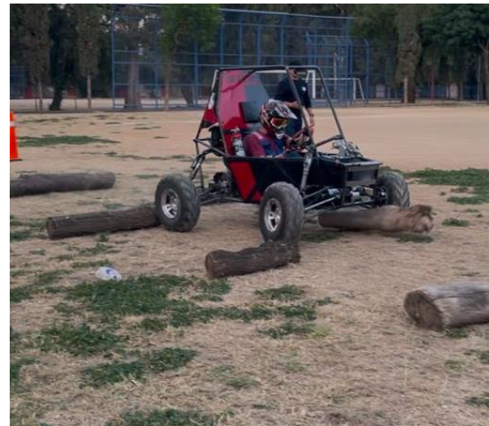
Figura 130. Prueba de suspensión y tracción
