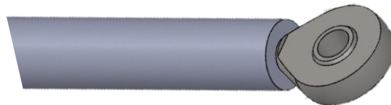
Figura 82. CAD de la bieleta de dirección con rótula.
