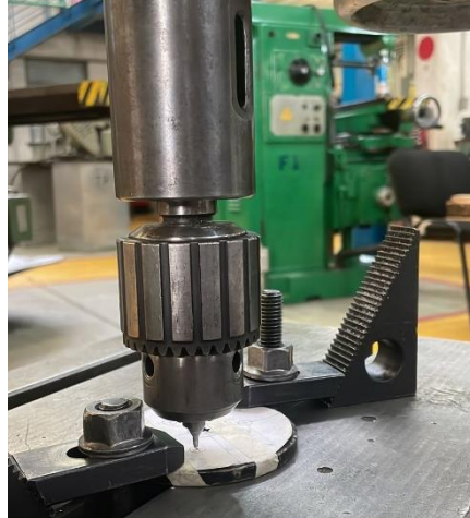
Figura 87. Proceso de barreno en la placa adaptación utilizando un taladro radial.
