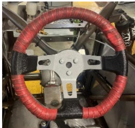
Figura 89. Cinta antiderrapante colocada en el volante.
