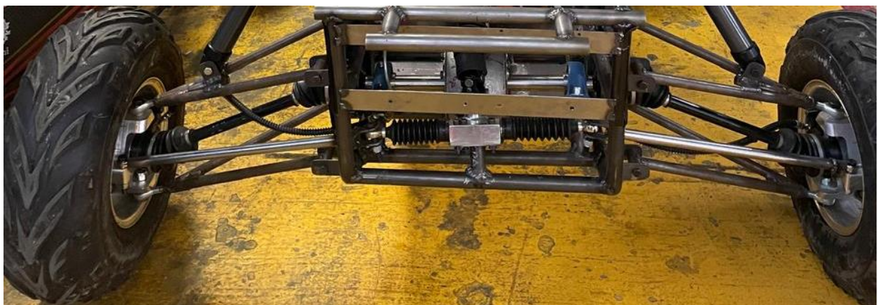
Figura 110. Cremallera montada con su soporte y bieletas conectadas a los portabaleros.
