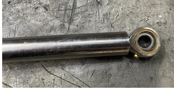
Figura 96. Rotula de 3/8" a un extremo de la bieleta.
