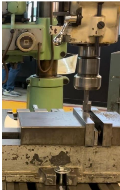
Figura 91. Fresadora llevando a cabo el corte vertical en el adaptador de la columna.
