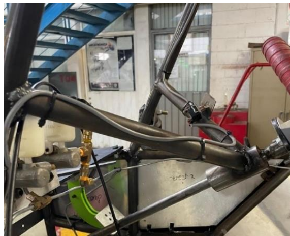
Figura 111. Soportes de la columna de dirección soldados a la jaula.
