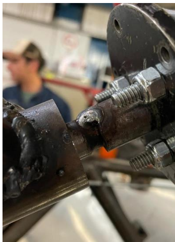
Figura 93. Columna soldada al segmento remanente de la placa de adaptación del volante.
