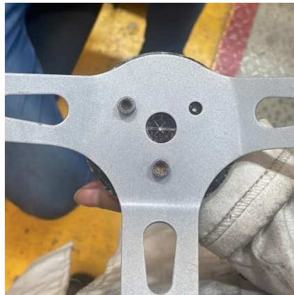
Figura 88. Tornillos instalados para verificar la correcta alineación y ubicación.
