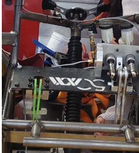
Figura 113. Cubrepolvos de plástico montados en la columna de dirección.
