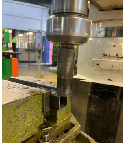
Figura 117. Corte vertical con fresadora del PTR.
