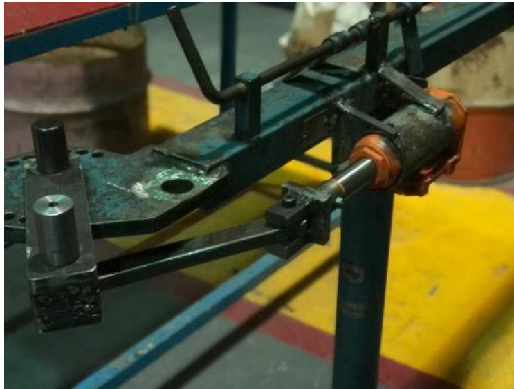
Figura 30.- Ensamble del mecanismo en la estructura de la dobladora.
