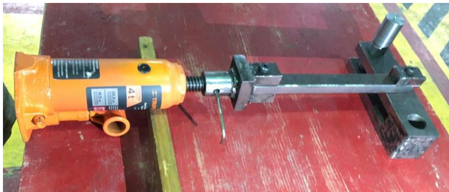
Figura 29.- Mecanismo base para el doblado con el gato hidráulico como fuente de transmisión de potencia.
