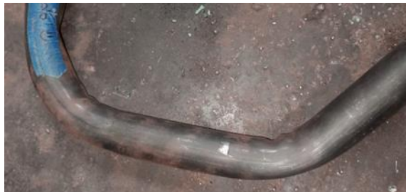
Figura 50.- Deformaciones en el tubo presentadas al realizar el doblado.
