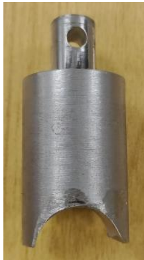
Figura 32.- Cabezal manufacturado para la máquina de ensayos INSTRON 5500R .
