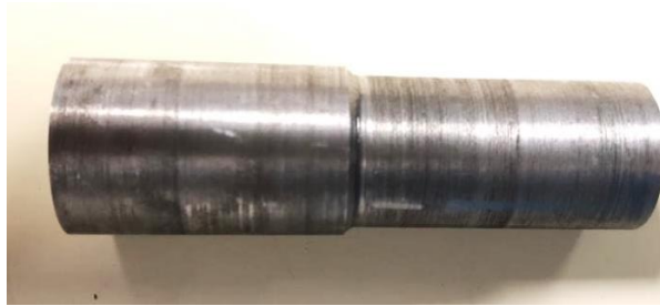
Figura 28.- Perno manufacturado de acero 1045 con un hombro.
