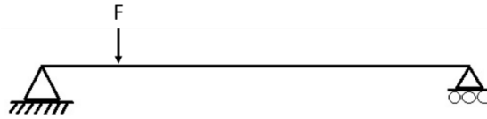
Figura 31.- Consideración para carga en el puente.
