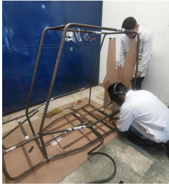
Figura IV.33 Colocación de miembros laterales de impacto
