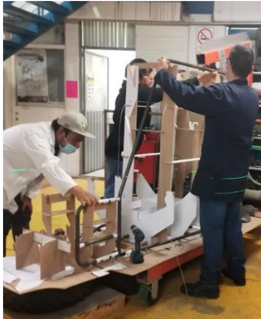
Figura IV.27 Montaje de tubos superiores
