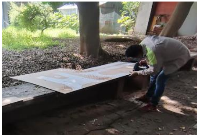
Figura IV.18 Corte manual de plantillas para el bastidor
