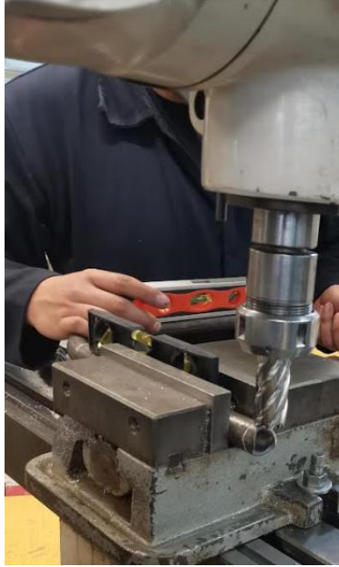
Figura IV.22 Bocas de pescado en fresadora
