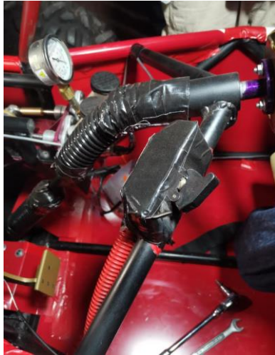
Figura IV.40 Encintando soporte de switch
