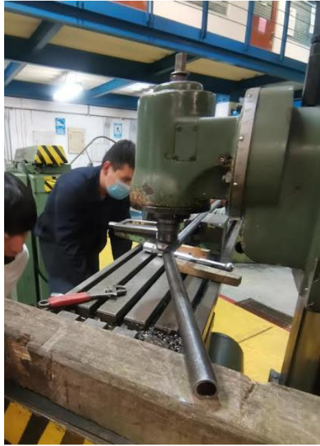
Figura IV.21. Rectificación de dobles en tubo
