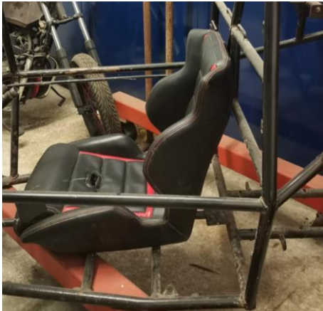
Figura III.3. Inclinación de pared de fuego y respaldo edición 2019
