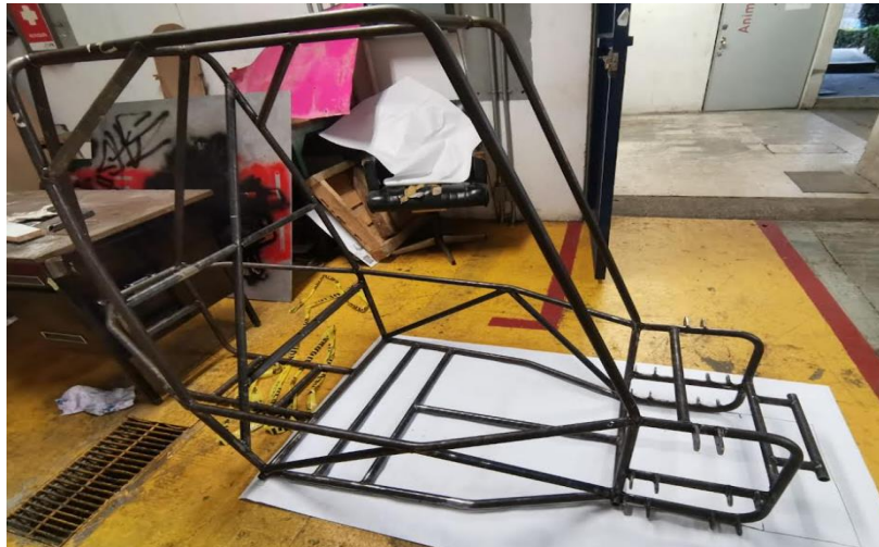
Figura IV.38 Estructura final completamente soldada
