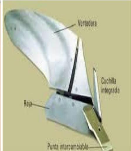
Figura 1. Herramienta para arado con timón. Figura 2. Elementos de la vertedera.
