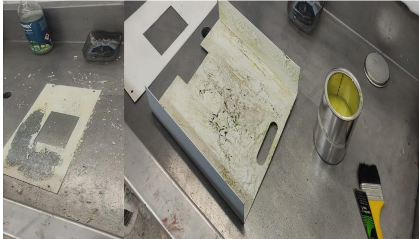
Figura 35.- Aplicación de removedor de pintura de la marca axalta.
