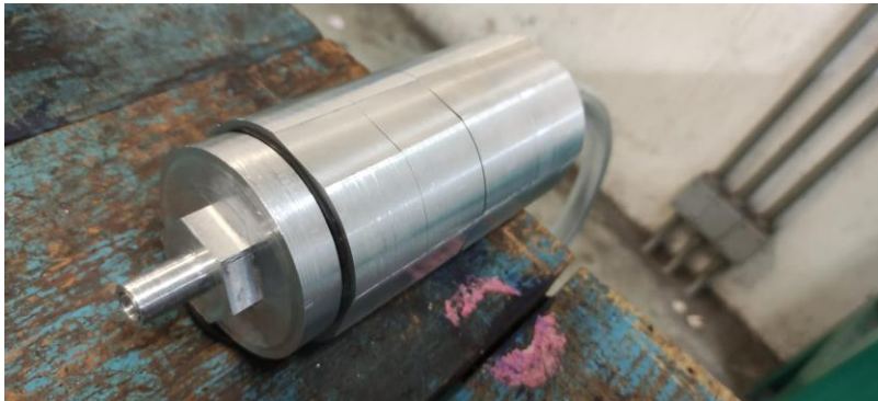
. Figura 44.- Ensamble y o rings como sistema de sellado.
