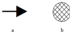
Figura 29.- Símbolos de representación de un apoyo [55].
