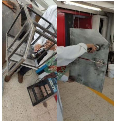
Figura 36.- Removiendo restos de pintura.
