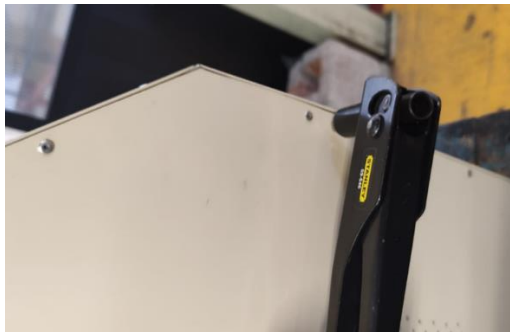
Figura 46. - Unión de la estructura utilizando remaches de 1/8".
