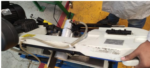
Figura 39.- Cortes de las barras en piezas de 8 cm.
