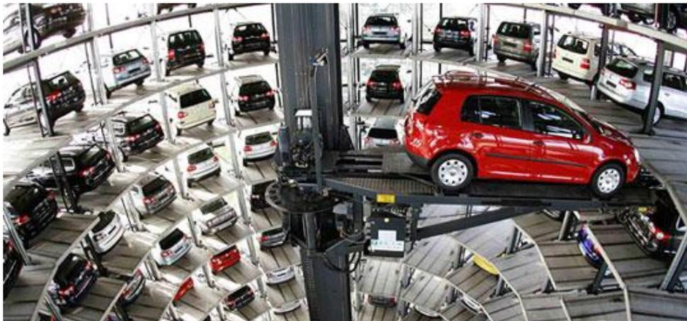
*Figura 7. Sistema de estacionamiento automatizado [10].*
