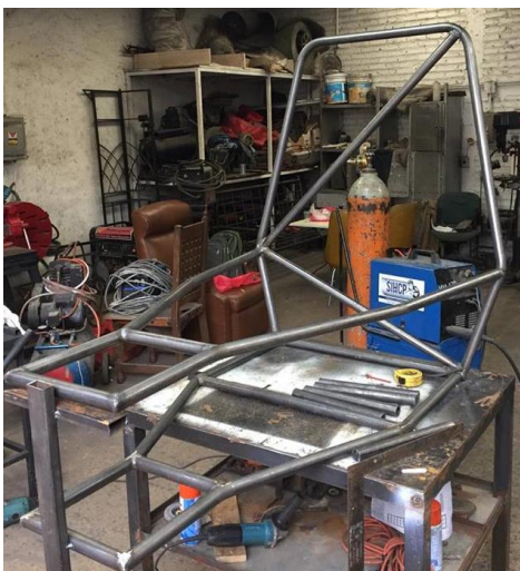
Ilustración 12 colocación refuerzos laterales
