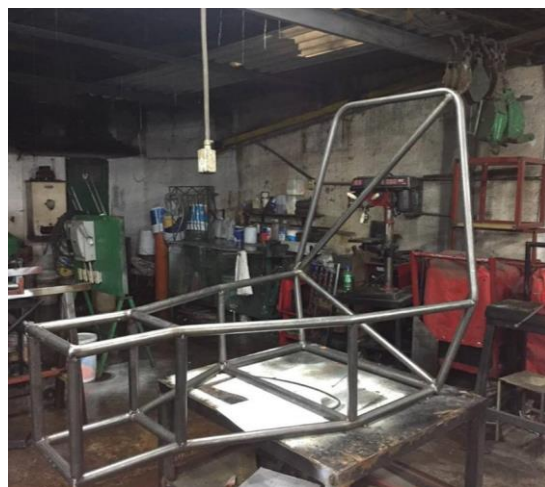
Ilustración 13 refuerzos laterales terminados
