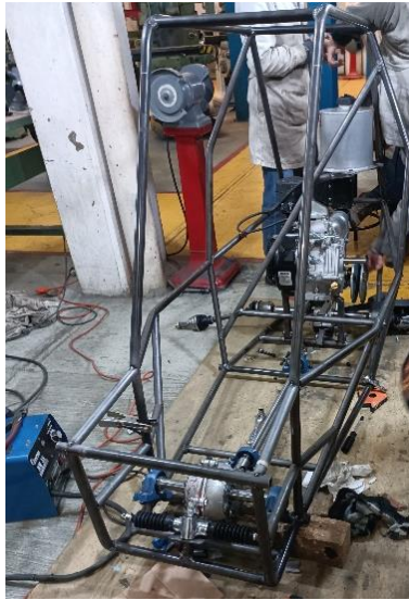
Figura 40.- Proceso de manufactura del chasis monocasco (Miembro SIM).
