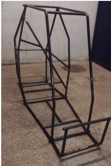
Figura 39.- Proceso de construcción del chasis (Refuerzo trasero).
