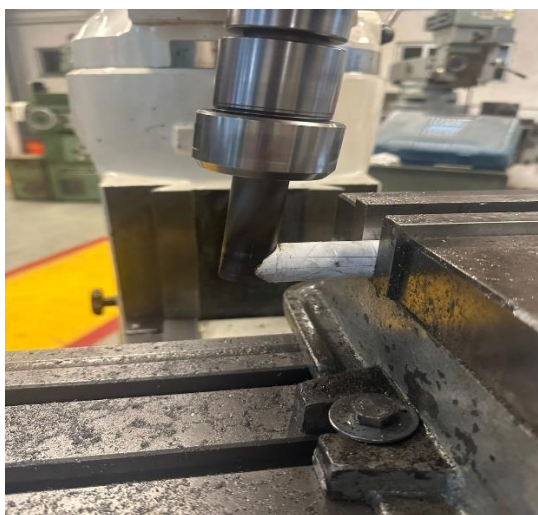
Figura 36.- Fresadora vertical con cortador anular para corte de boca de pescado.
