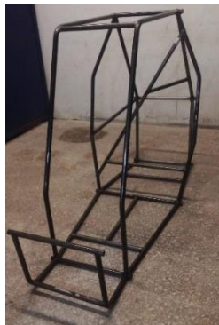
Figura 27.- Jaula en proceso de fabricación.
