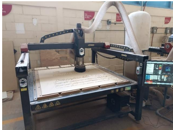
Figura 31.- Router CNC para corte de MDF.
