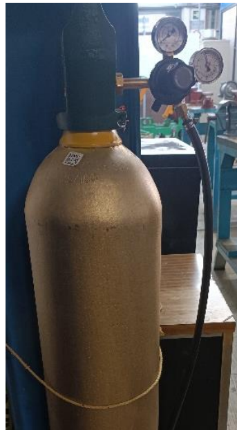
Figura 4.- Tanque de gas (CO 2 y Argón).
