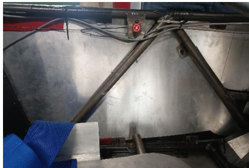
Figura 43.- Paneles entre SIM y LFS.
