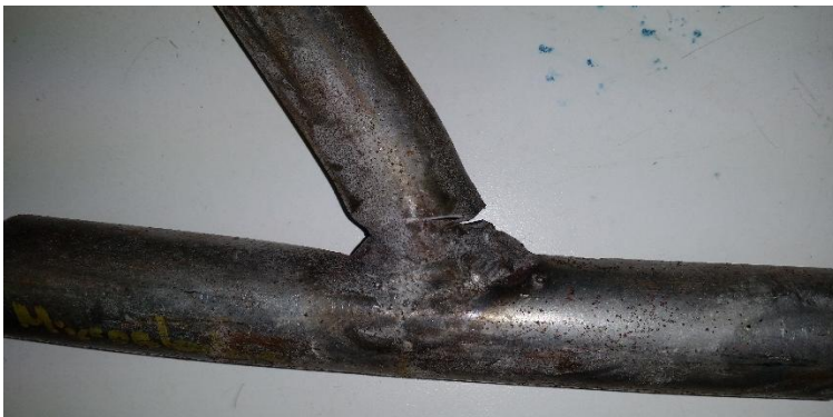
Ilustración 79 muestra de soldadura
