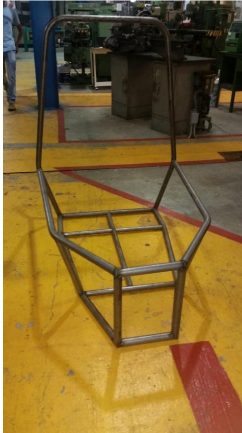
Ilustración 65 proceso de armado de la jaula antivuelco 2018
