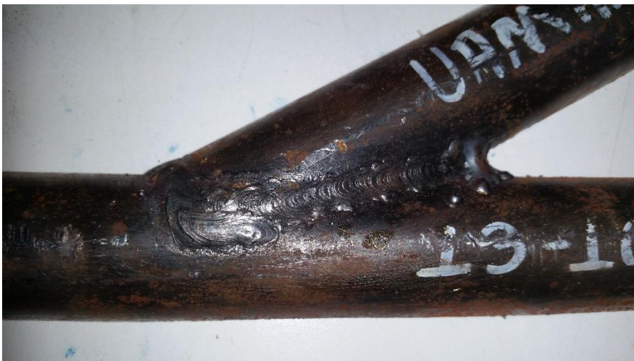
Ilustración 83 muestra de soldadura
