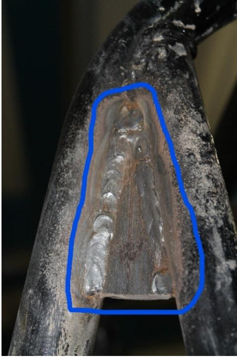
Ilustración 86 placa de refuerzo
