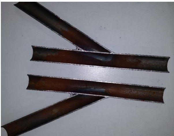
Ilustración 81 muestra de soldadura
