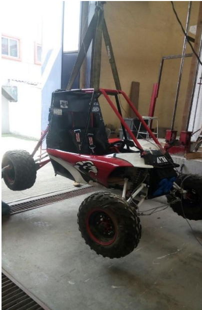
Ilustración 29 pesando el vehículo baja SAE 2017
