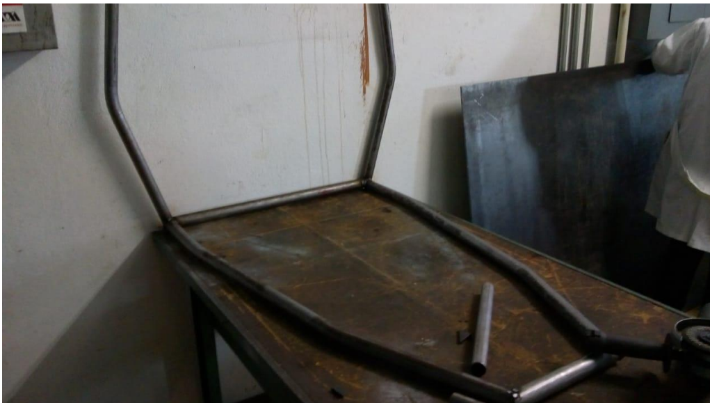
Ilustración 64 proceso de armado de la jaula antivuelco 2018
