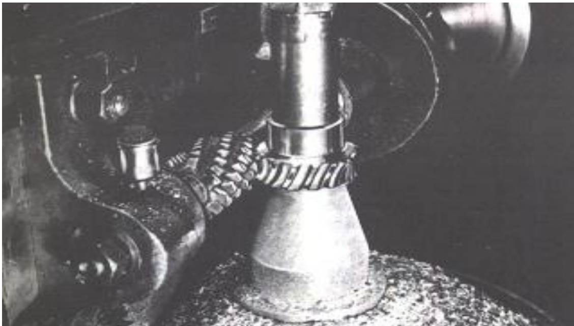
Fig. 34 Generación de un engrane sinfín con fresa madre. (Cortesía de BostanGear Works, Inc.) [7].
