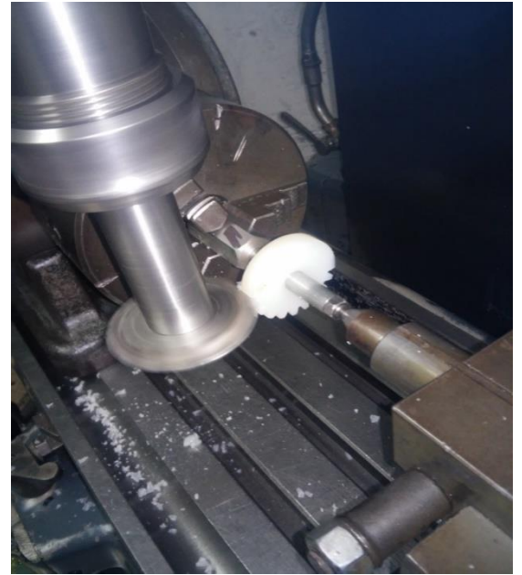
Foto 11 Forma de dientes en fresadora.
