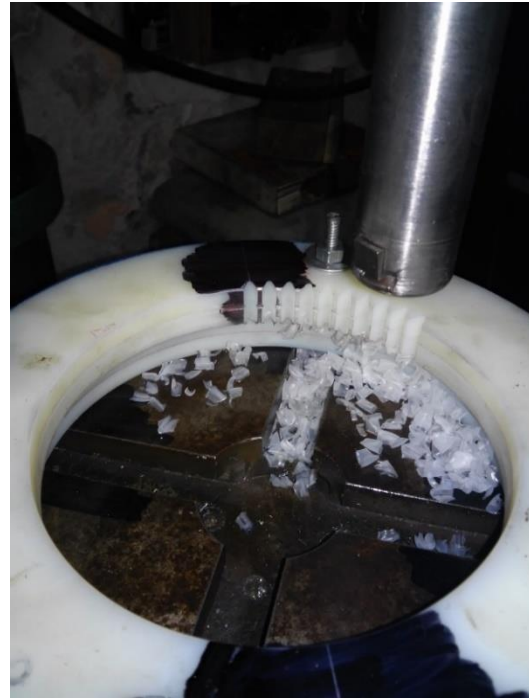
Foto 7 Maquinado de engrane corona.
