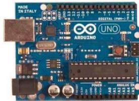
*Fig. 5 Tarjeta de adquisición de datos Arduino*
