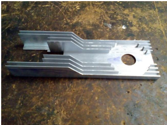
Imagen 6.8. Soporte después del barrenado
