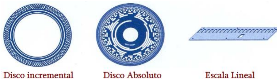
Figura 5.10. Tipos de encoders ópticos.
