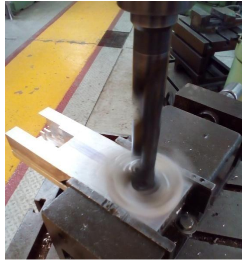
Imagen 6.7 Barrenando el soporte
