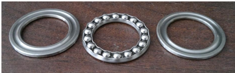
Imagen 6.13. Partes del rodamiento axial.
