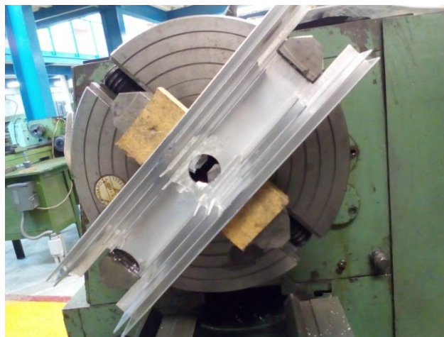
Imagen 6.5. Base de soporte de la cabeza móvil montada en el torno.
