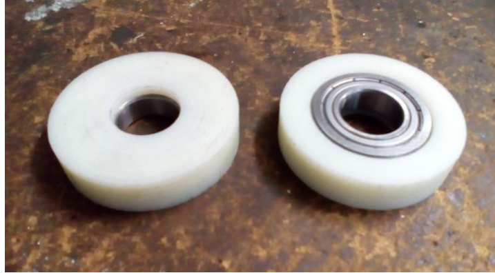
Imagen 6.10. Rodamientos acoplados en cajas de Nylamid .
