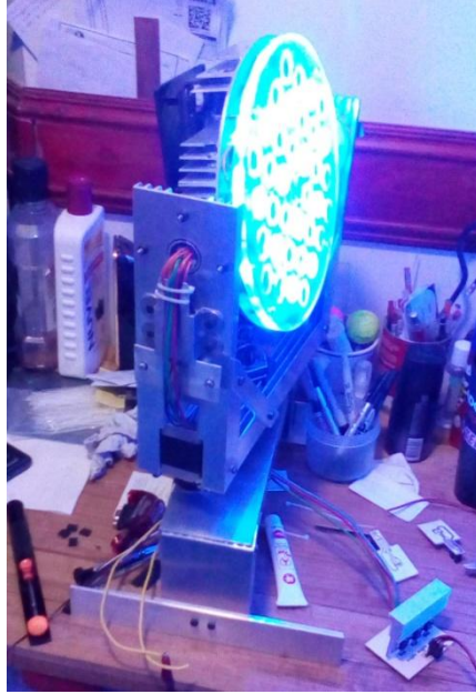
Imagen 7.17. Vista del prototipo con los LEDs azules encendidos.
