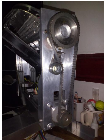
Imagen 7.14. Vista lateral, sistema banda-poleas, eje vertical.
