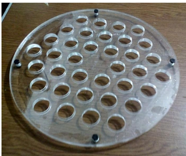
Imagen 6.20. Corte de acrílico terminado.
