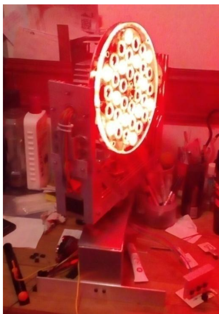
Imagen 7.18. Vista del prototipo con los LEDs rojos encendidos.
