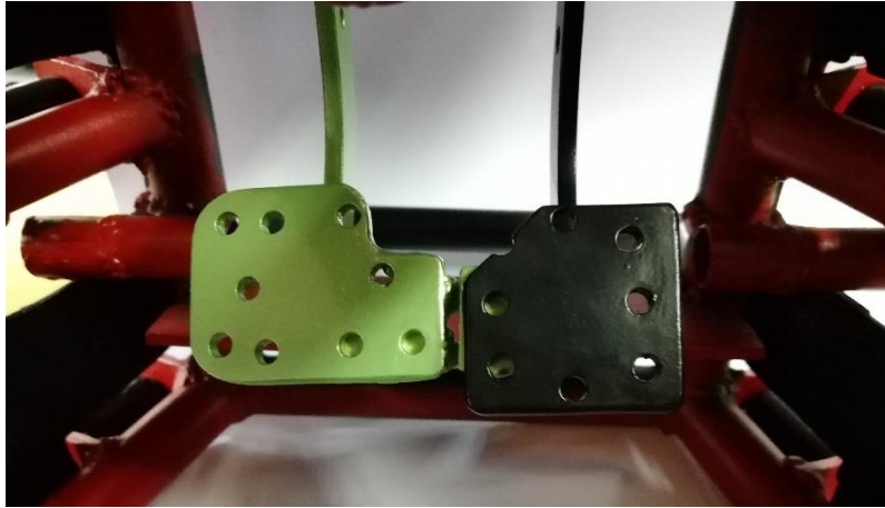
Figura 33. Instalación de doble pedal de freno.
