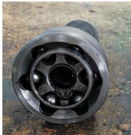
Figura 27. Junta homocinética reparada, estriado requerido.
