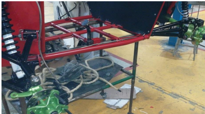
Figura 25. Líneas rígidas y flexibles montadas en jaula.
