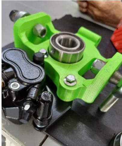
*Figura 46. Ensamble de caliper y rodamiento en impresión 3D.*
