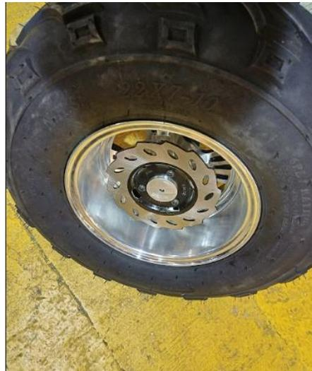
Figura 17. Ensamble maza, disco, rin y llanta.
