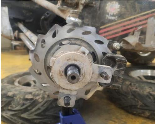
*Figura 74. Ruptura de la maza.*
