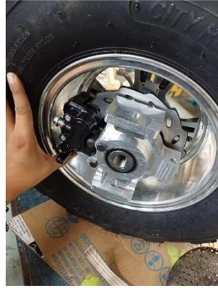
Figura 50. Ensamble de elementos de masas no suspendidas.
