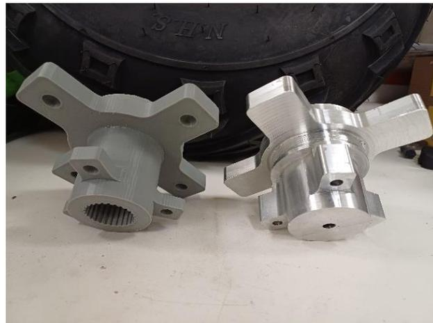
*Figura 36. Maza elaborada en impresión 3D y maza elaborada en fresadora CNC.*
