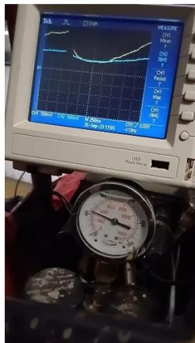
*Figura 68. Prueba de presión con osciloscopio en cilindros maestros.*
