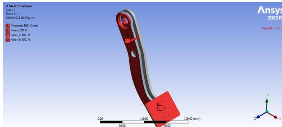
*Figura 63. Cargas aplicadas al pedal de freno.*
