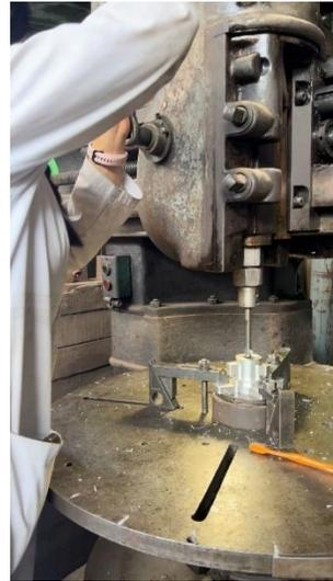
*Figura 37. Proceso de manufactura del astriado.*
