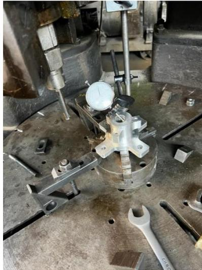
*Figura 38. Nivelación de la pieza con indicador de carátula.*
