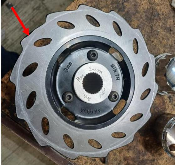
Figura 16. Área de contacto de la balata y el disco.
