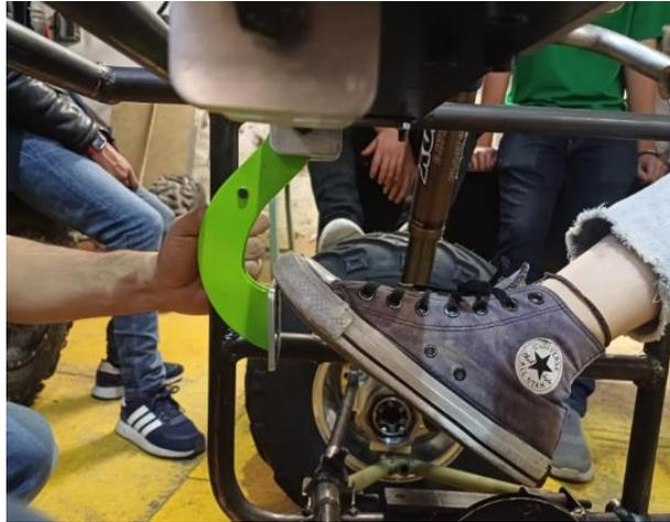
Figura 60. Prueba de la carrera del pedal.
