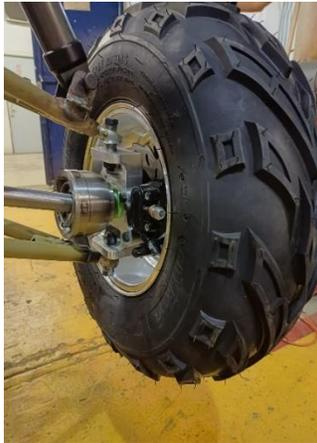
*Figura 58. Masas no suspendidas delanteras ensambladas con la suspensión.*
