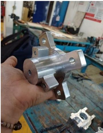
*Figura 35. Maza con barrenos.*
