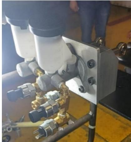
*Figura 20. Accesorios para tubería conectados a los cilindros maestros.*
