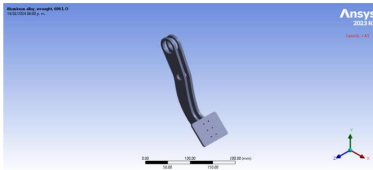
Figura 61. Pedal de freno de aluminio 6063 T5 [17].
