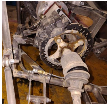
Figura 50. Ensamble del disco de freno trasero con el caliper.
