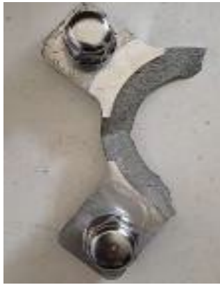
Figura 3. Fragmento de la maza fracturada.
