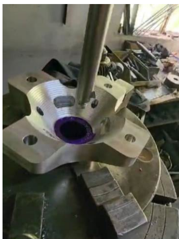
Figura 32. Proceso de astriado en una maza.
