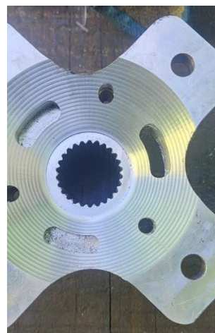
Figura 33. Astriado terminado en una maza
