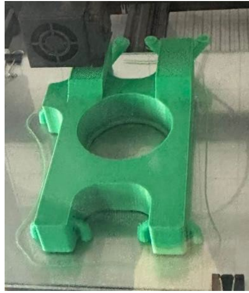
Figura 39. Impresión 3D portabaleros trasero.
