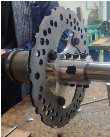
Figura 49. Ensamble del disco de freno trasero al eje.
