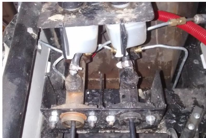
Figura 110. Tuerca de acero 3/16 con avellanado bubble flare [31].
