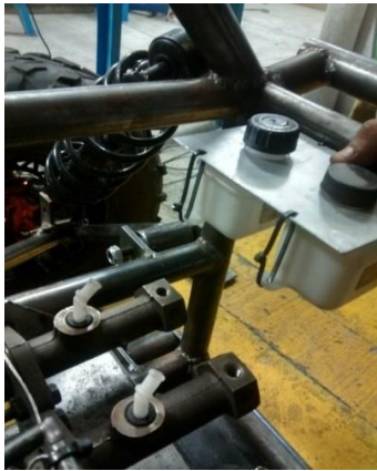
Figura 16. Cilindros maestros con depósito de líquido de frenos.
