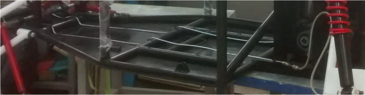
Figura 24. Líneas rígidas montadas en vehículo.
