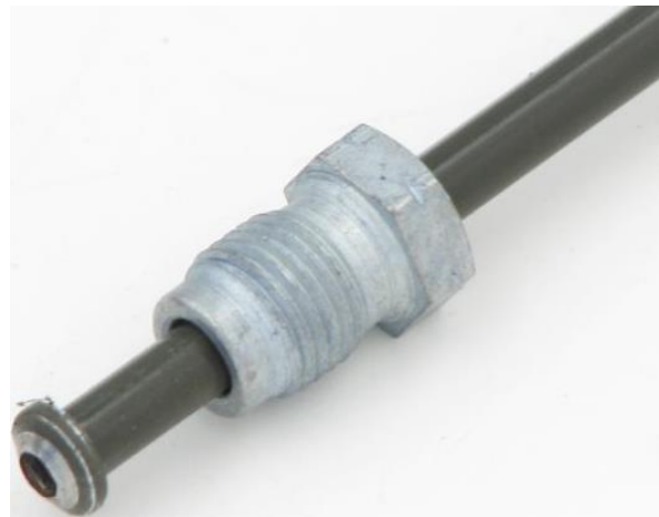
Figura 107. Tuerca de acero 3/16 con avellanado bubble flare [31].
