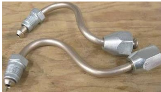
Figura 98. Dobleces altamente pronunciados [27].
