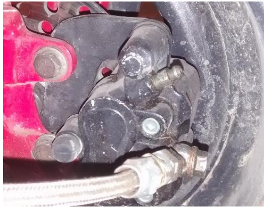
Figura 20. Caliper de doble pistón, con el purgador arriba.
