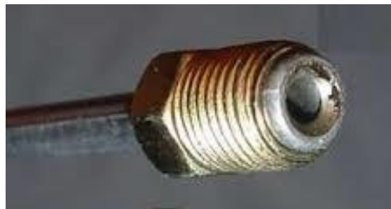
Figura 109. Tuerca de acero 3/16 con avellanado bubble flare [31].
