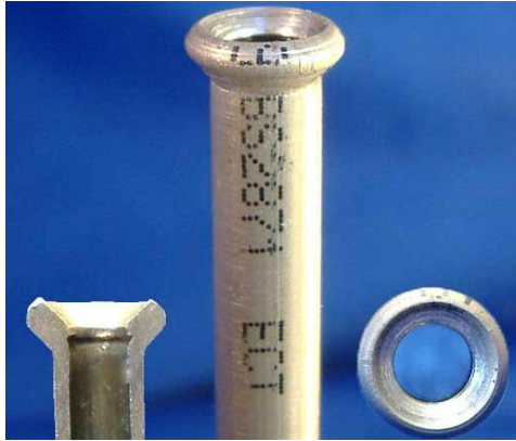
Figura 108. Tuerca de acero 3/16 con avellanado bubble flare [31].
