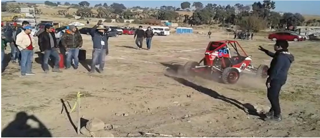
Figura 39. Prueba que exigía el amarre de las cuatro ruedas con el accionamiento del pedal.
