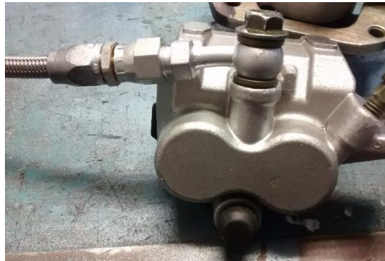
Figura 31. Línea de freno flexible conectada al caliper.
