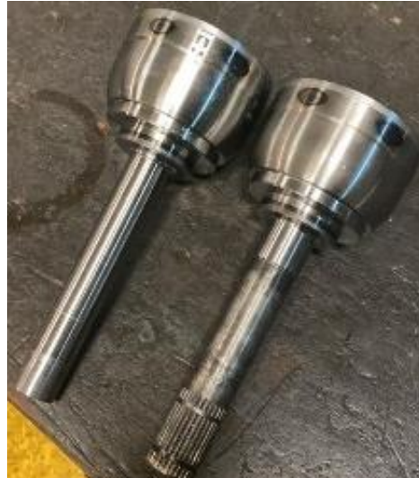
Figura 71. Espiga en proceso de manufactura.
