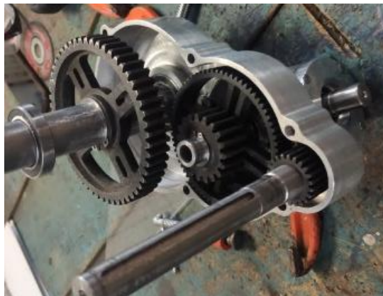
Figura 32. Ensamble de caja de engranes.
