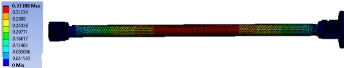
Figura 65. Desplazamiento y escala de colores, semieje 19.05 mm.
