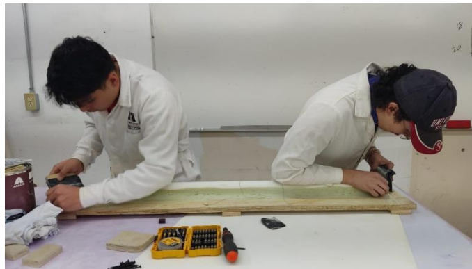
Figura 84. Lijado del molde.
