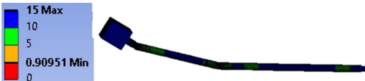
Figura 74. Desplazamiento y escala de colores, cardán 25.4 mm.
