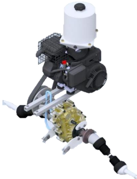
Figura 1. Sistema de transmisión de potencia 4x2.
