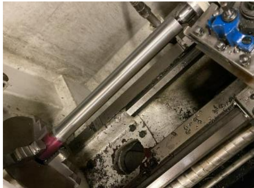
Figura 69. Cilindrado de las piezas.
