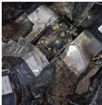
Figura 41. Soportes colocados del diferencial delantero.
