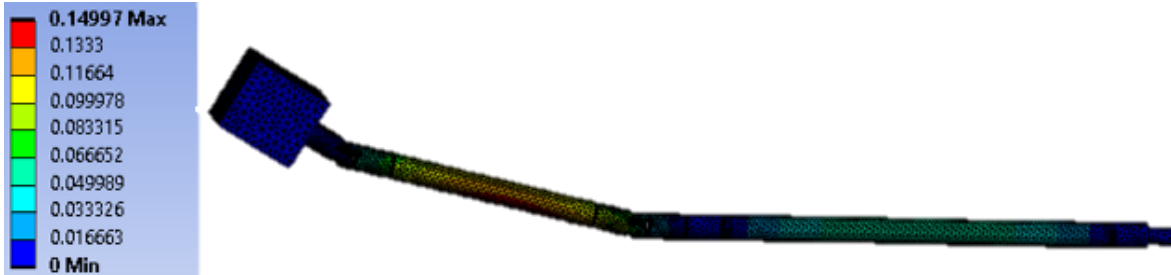
Figura 74. Desplazamiento y escala de colores, cardán 25.4 mm.
