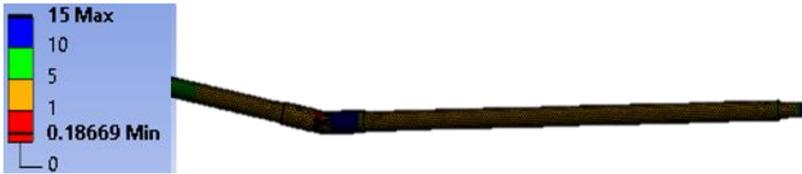
Figura 78. Figura 30: Factor de seguridad dinámico, cardán 22.2 mm.
