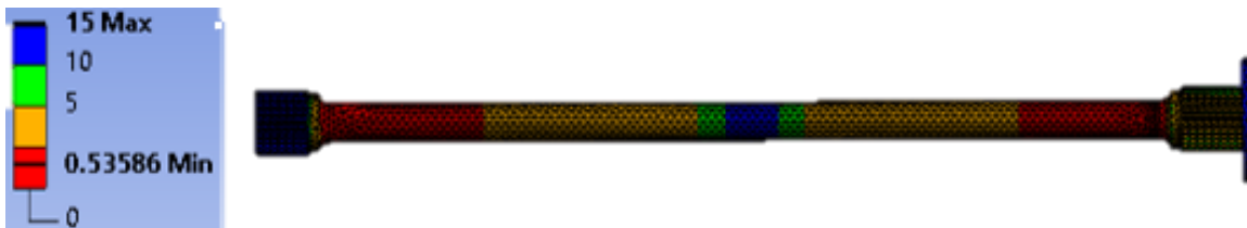
Figura 67. Factor de seguridad dinámico, semieje 19.05 mm.
