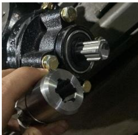
Figura 39. Astriado hembra con diferencial delantero.
