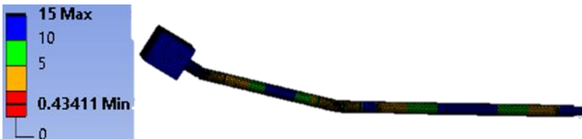
Figura 76. Factor de seguridad dinámico, cardán 25.4mm
