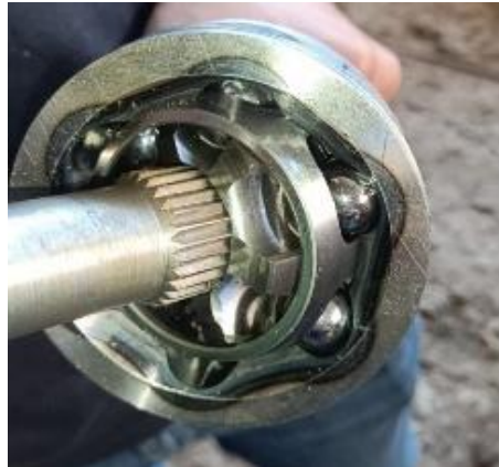
Figura 73. Unión semieje con espiga.
