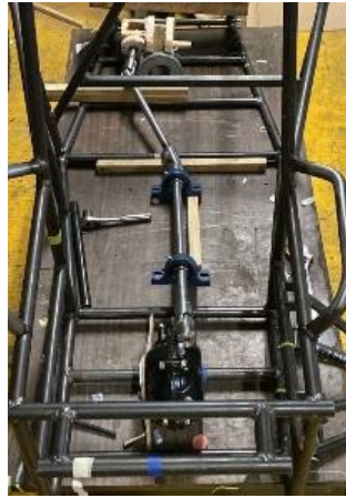
Figura 40. Cardán armado en el vehículo.
