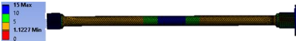
Figura 66. Factor de seguridad estático, semieje 19.05 mm.
