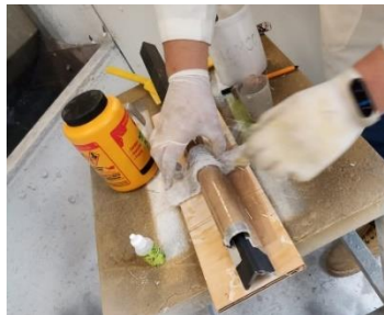
Figura 85. Colocado de cintas en el molde.
