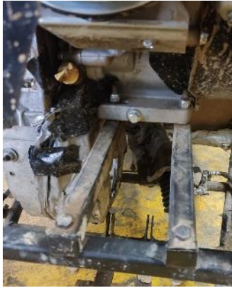
Figura 43. PTR como soporte del motor.
