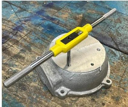
Figura 39. Roscado en barrenos
