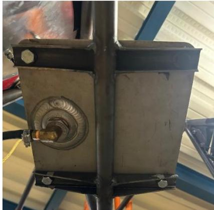
Figura 72. Soporte del tanque de gasolina vista inferior.
