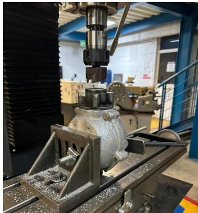
Figura 41. Ranurado en la parte frontal
