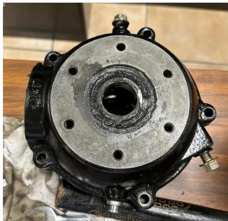
Figura 43. Baleros del diferencial delantero dañados
