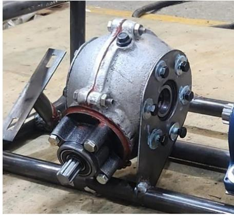
Figura 42. Ensamble del diferencial delantero
