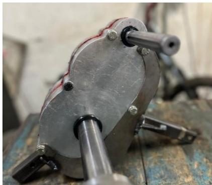
Figura 56. Ensamble del soporte de la caja de reducción trasera.
