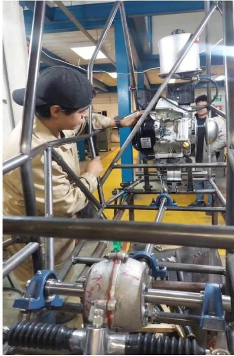
Figura 65. Ensamble del sistema de potencia parte delantera.
