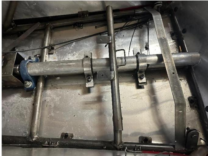
Figura 67. Protección del eje de transmisión (cardán).
