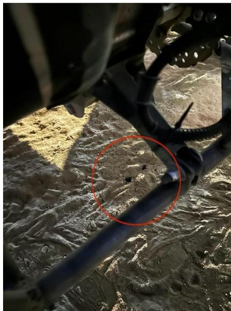
Figura 98. Fuga de aceite de la caja de reducción trasera
