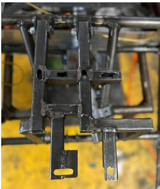
Figura 80. Modificación del soporte del motor.
