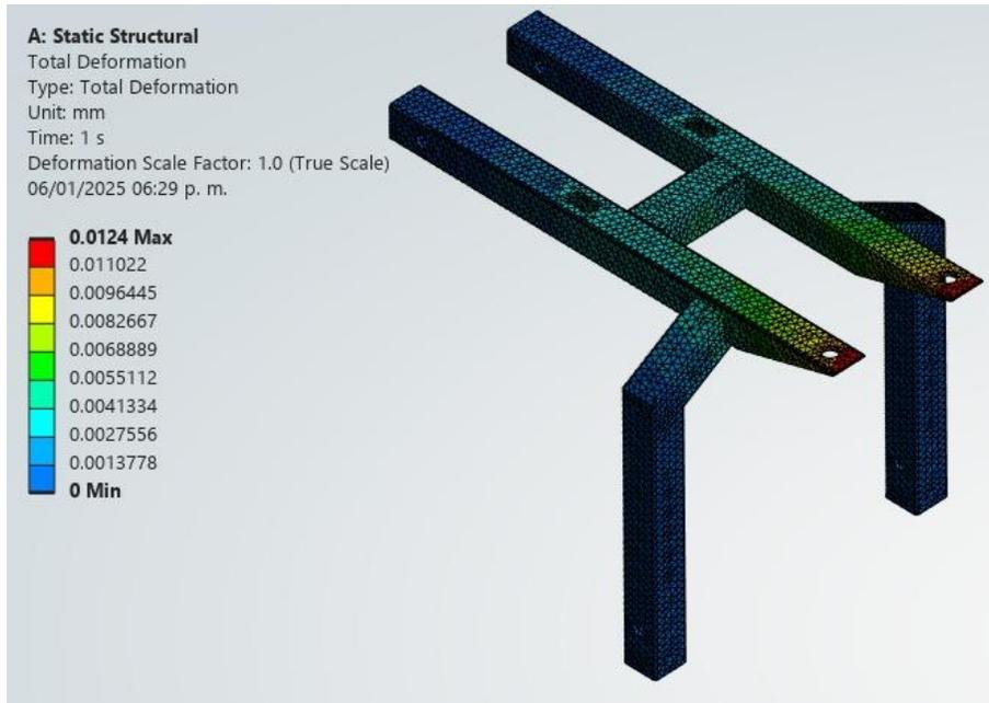
Figura 74. Deformación total del soporte de motor.
