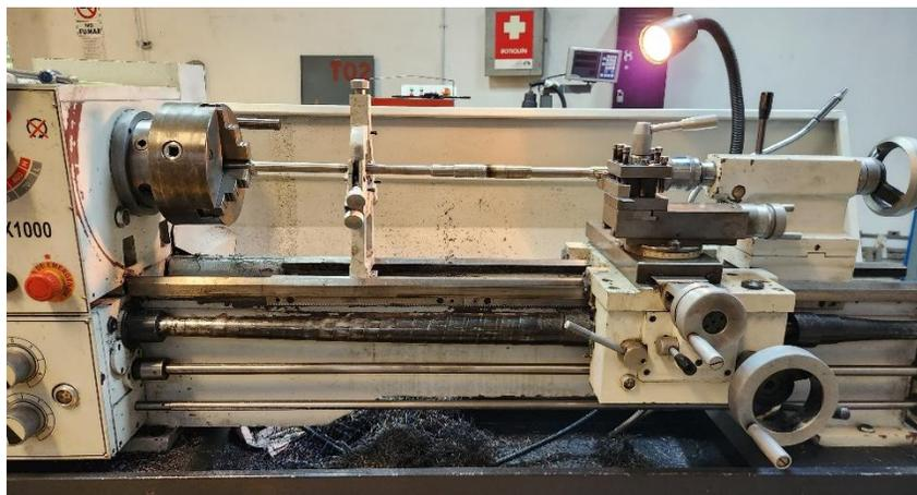
Figura 47. Cilindrado a 7/8 de pulgada.
