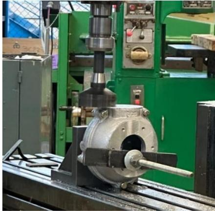
Figura 40. Fresado en la parte frontal
