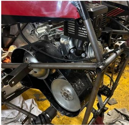
Figura 71. Resultado final de la protección de la CVT.
