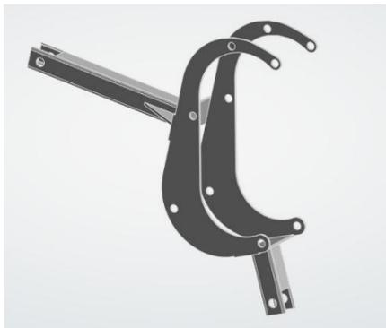
Figura 52. Soporte de la caja de reducción trasera.
