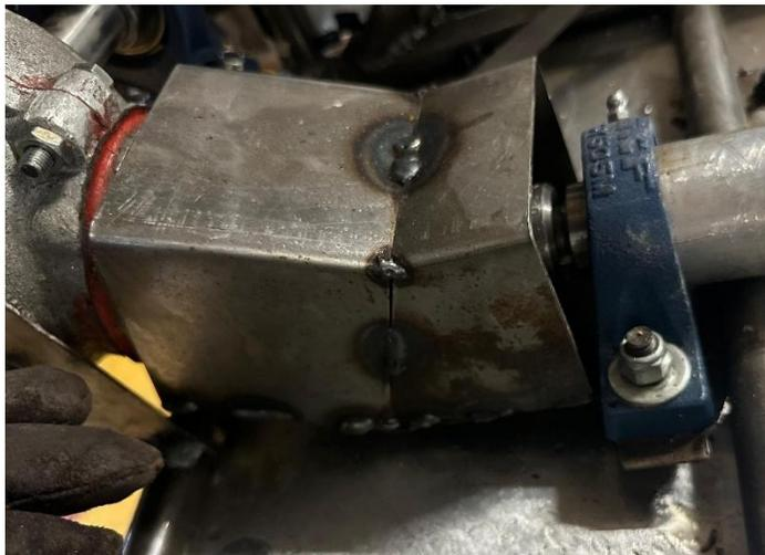
Figura 68. Protección de juntas universales.
