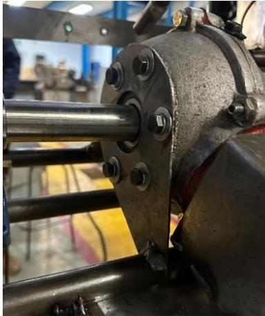
Figura 55. Ensamble del soporte del diferencial.
