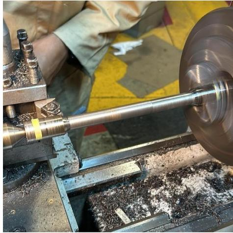
Figura 48. Cilindrado a 39/64 de pulgada.
