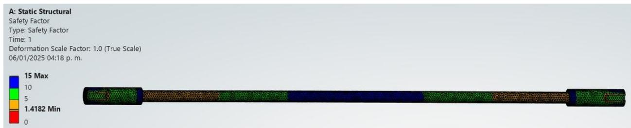
Figura 88. Factor de seguridad del eje cardán.
