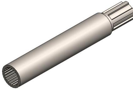
Figura 46. Diseño del cople.
