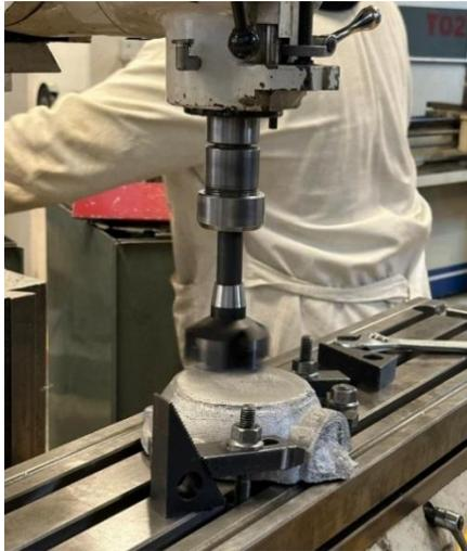
Figura 37. Desbaste en fresadora
