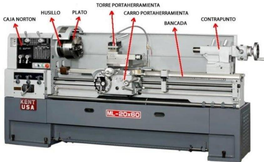
Figura 22. Partes de un torno [14].
