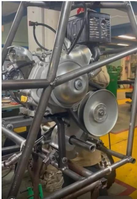
Figura 66. Ensamble del sistema de potencia parte trasera.
