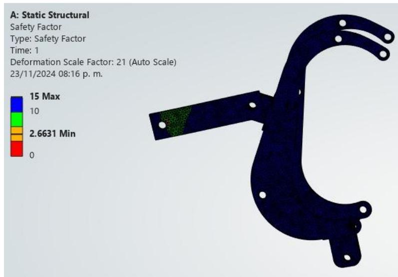
Figura 82. Factor de seguridad del soporte de la caja de reducción trasera.
