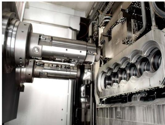
*Figura 10. Maquinado cabeza de motor [13].*
