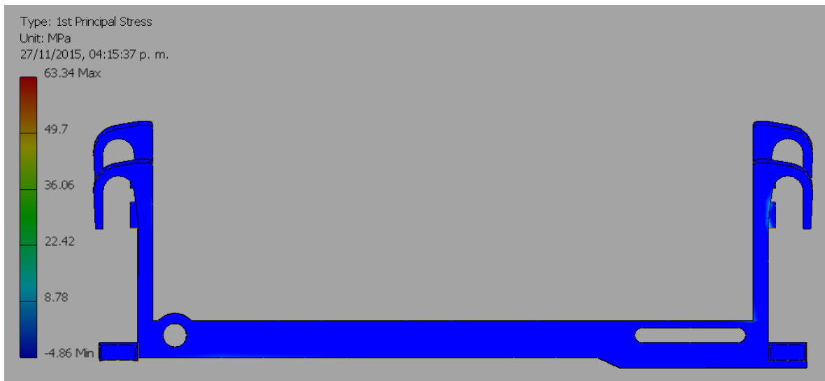
Figura 163 Distribución de esfuerzos de tensión en la base AB.
