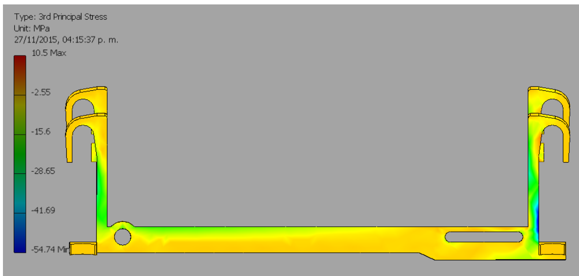
Figura 164 Distribución de esfuerzos de compresión en la base AB.
