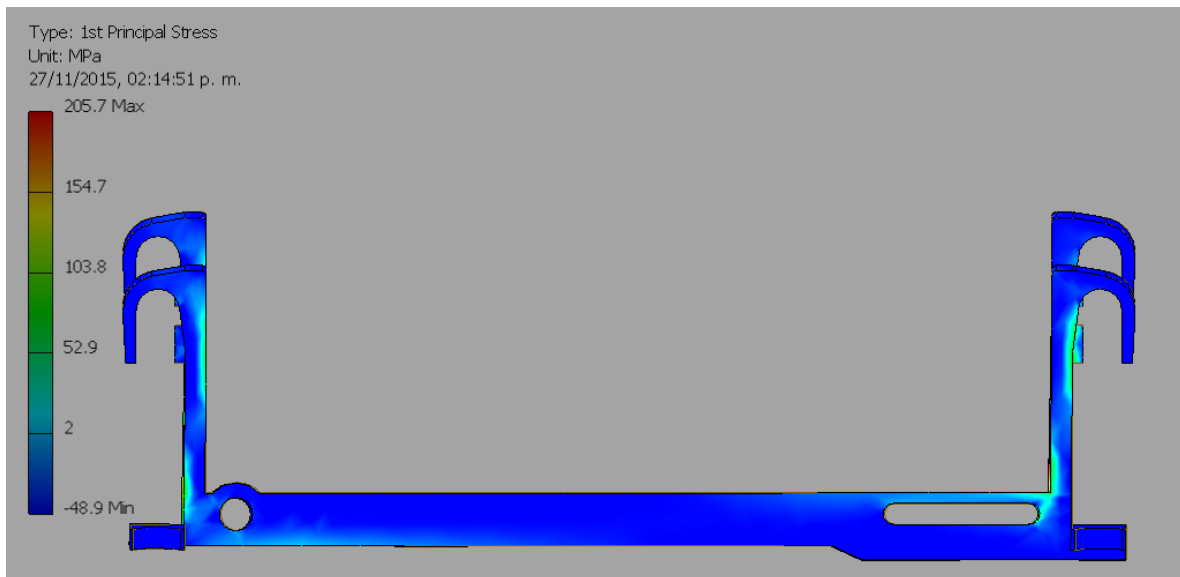
Figura 88 Distribución de esfuerzos de tensión en la base AB.
