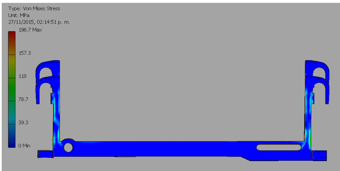
Figura 87 Distribución del esfuerzo equivalente en la base AB.
