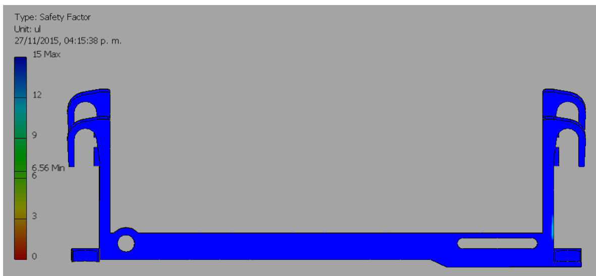
Figura 166 Factor de seguridad en la base AB.
