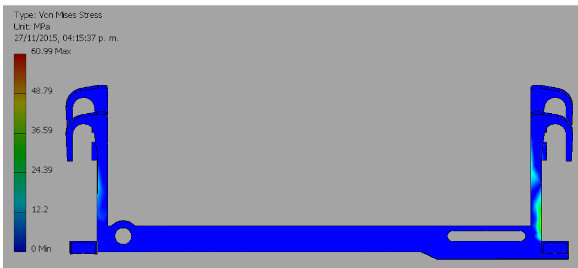
Figura 162 Distribución del esfuerzo equivalente en la base AB.
