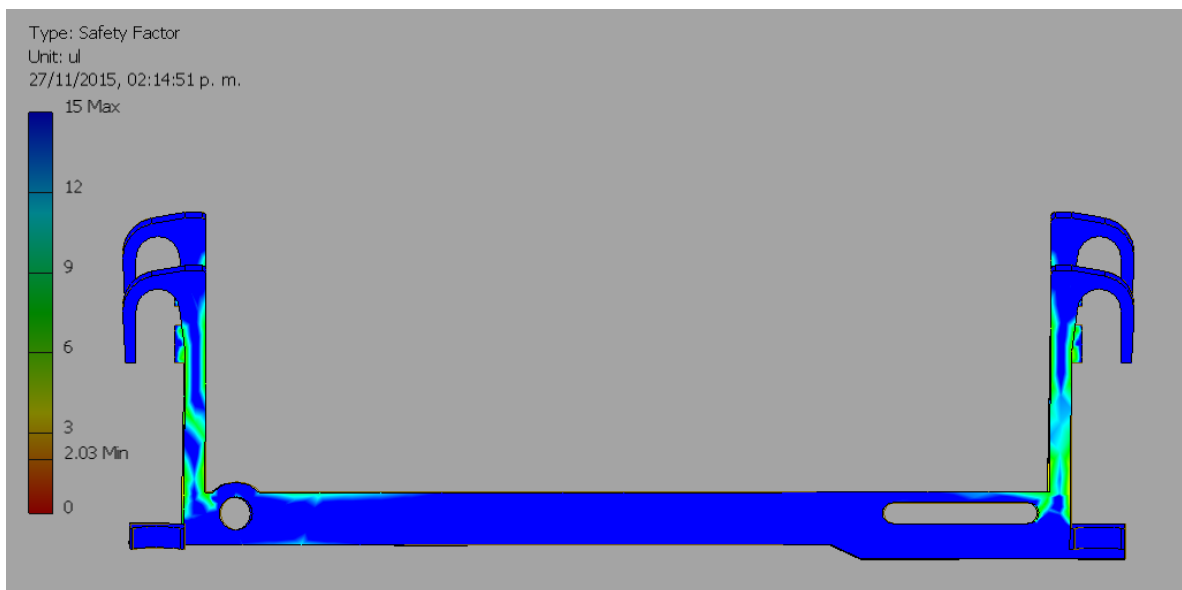
Figura 91 Factor de seguridad en la base AB.
