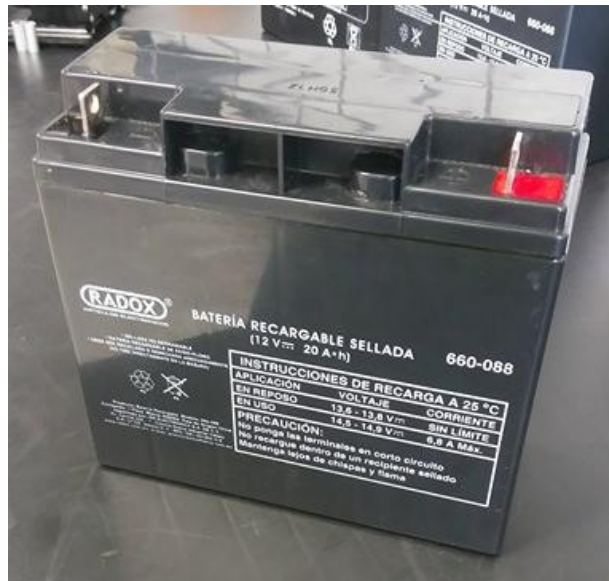
Imagen 24. Batería para los motores.
