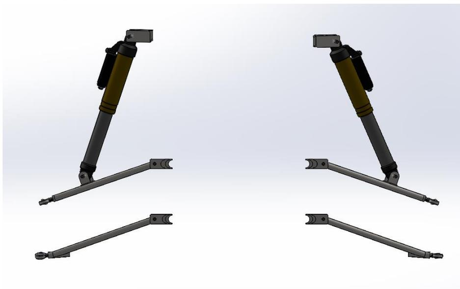
**Figura 7.5** Vista frontal del CAD de la suspensión delantera.
