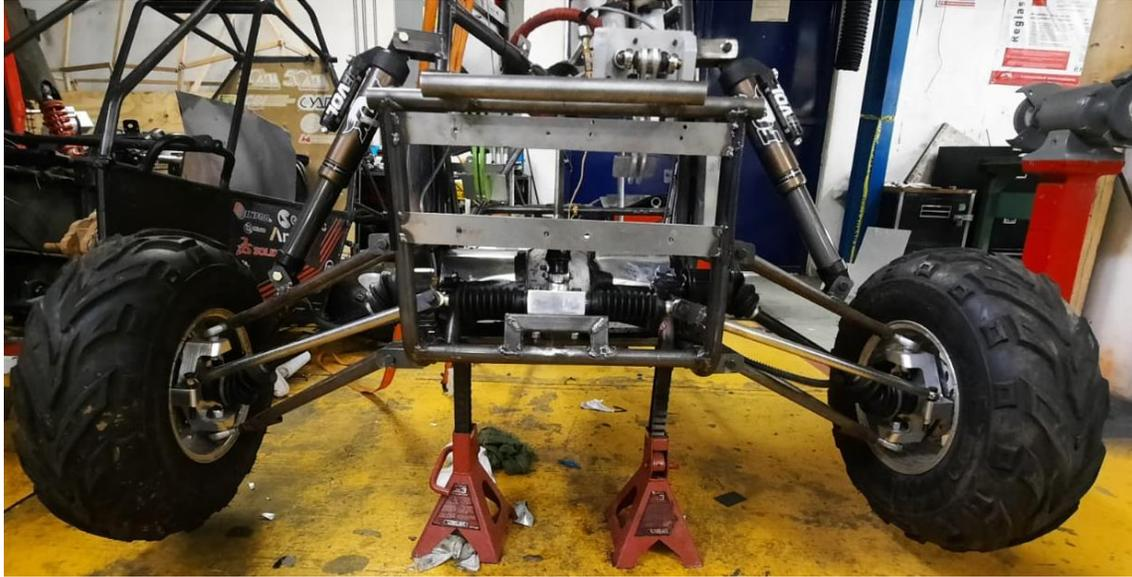
**Figura 7.30** Sistema de suspensión delantero desde una vista frontal al vehículo.
