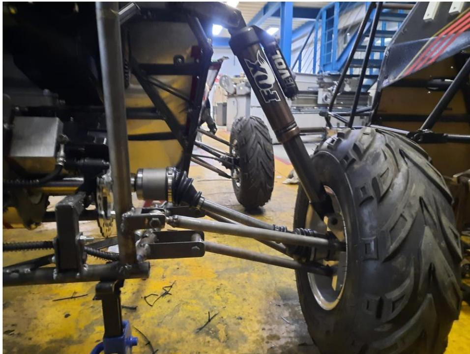
**Figura 7.31** Sistema de suspensión delantero en el lado izquierdo del vehículo.
