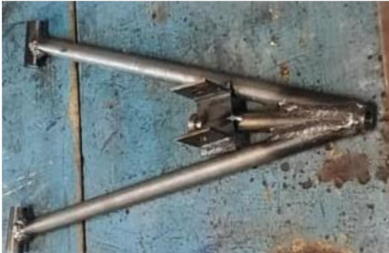
**Figura 7.19** Horquilla delantera izquierda.
