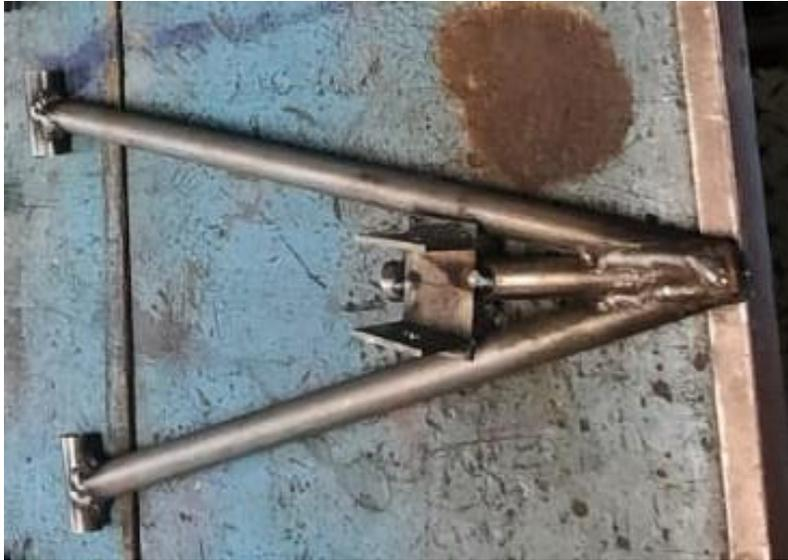
**Figura 7.18** Horquilla delantera derecha.
