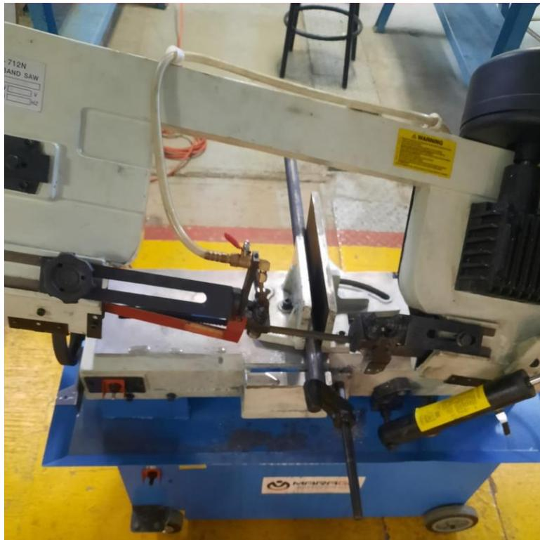
**Figura 6.45** Corte de tubo con la sierra cinta
