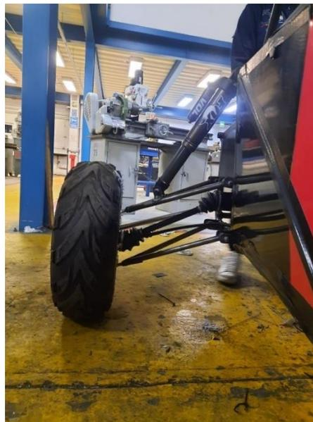
**Figura 7.29** Sistema de suspensión delantero en el lado derecho del vehículo.
