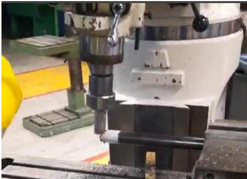
**Figura 6.48** Maquinado de bocas de pescado en la fresadora.
