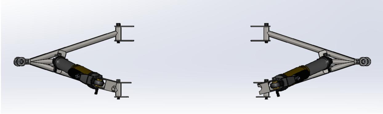
**Figura 7.6** Vista superior del CAD de la suspensión delantera.
