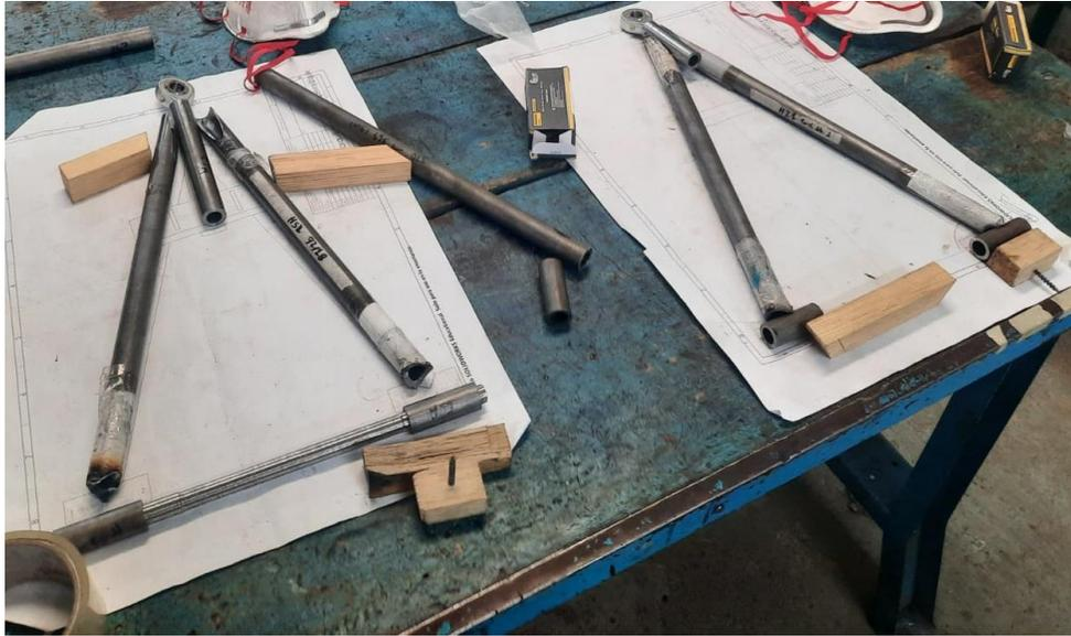
**Figura 6.49** Moldes de las horquillas delanteras.
