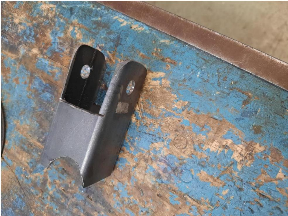
**Figura 7.21** Soporte del amortiguador delantero.
