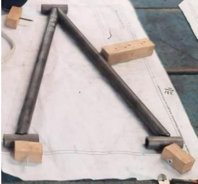
**Figura 6.52** Molde de la horquilla trasera.
