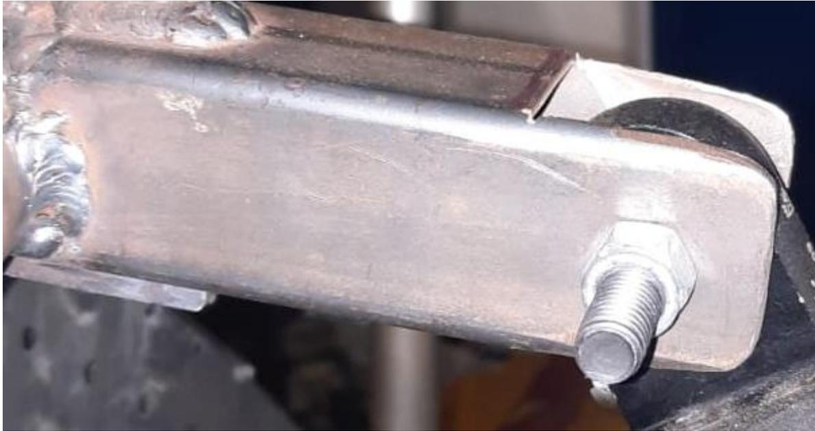
**Figura 7.26** Soporte de amortiguador trasero.
