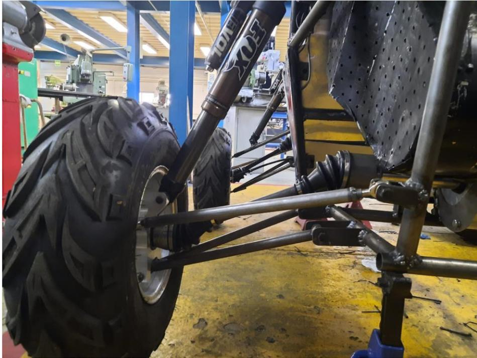
**Figura 7.32** Sistema de suspensión delantero en el lado derecho del vehículo.
