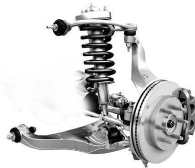
Figura 6.7 suspensión tipo doble A
