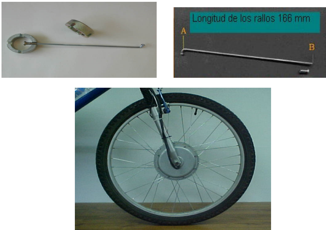
Figura 32 Rallos y motor acoplado al rin de la bicicleta
