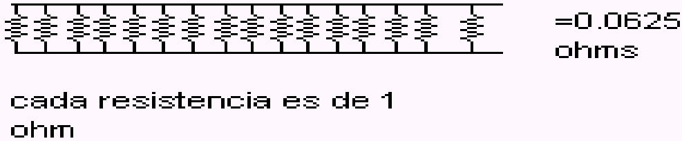
Figura 43 conjunto de resistencias en paralelo con valor de 0.625 ohms
