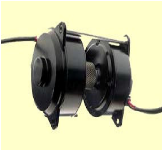
Figura 29 motor ZAP con roce en la llanta trasera por medio de un cilindro de aluminio
