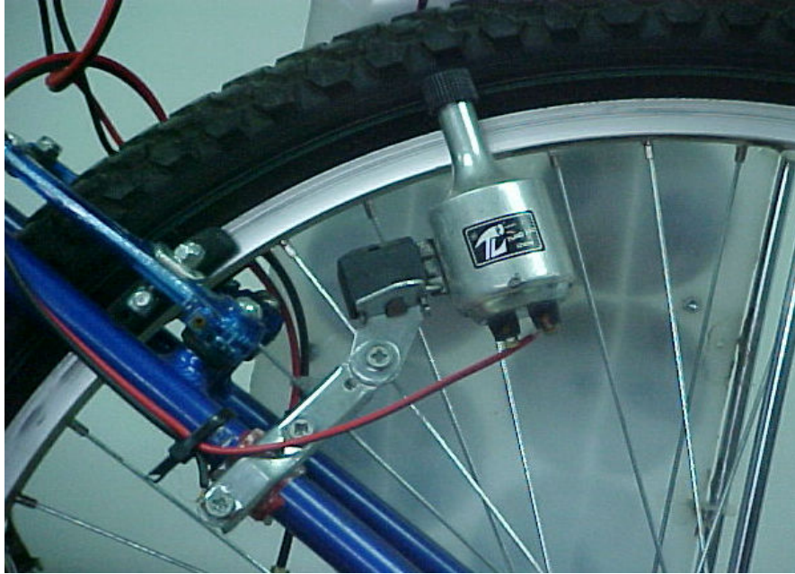
Figura 50 Fijación del dínamo en llanta trasera
