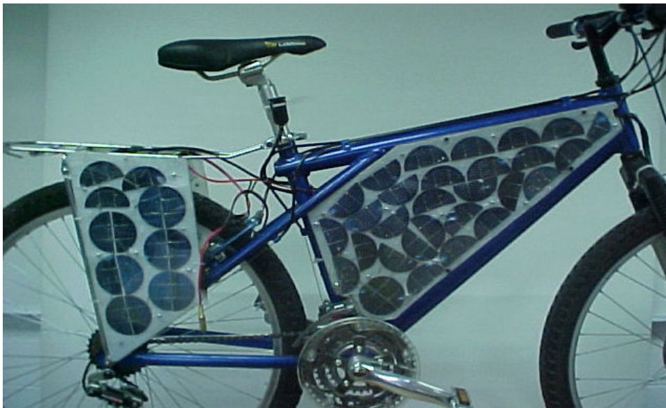
Figura 63 Vista de las áreas para colocación de los paneles solares
