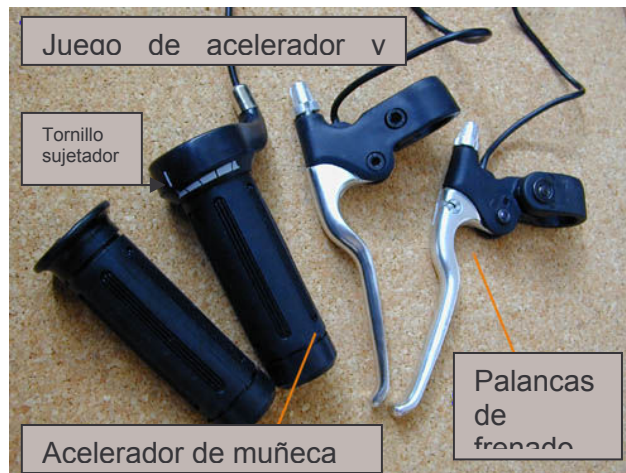
Figura 34 Acelerador tipo muñeca (hall-effect sensor). 0-5 VCD(0 volts=máxima velocidad, 5 volts=mínima velocidad) ajustable al manubrio de la bicicleta por medio de un tornillo tipo allen y palanca para frenos. (marca comercial)
