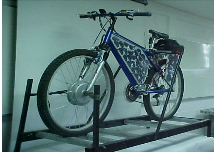
Figura 79 Montaje de la bicicleta en banco de ensayos
