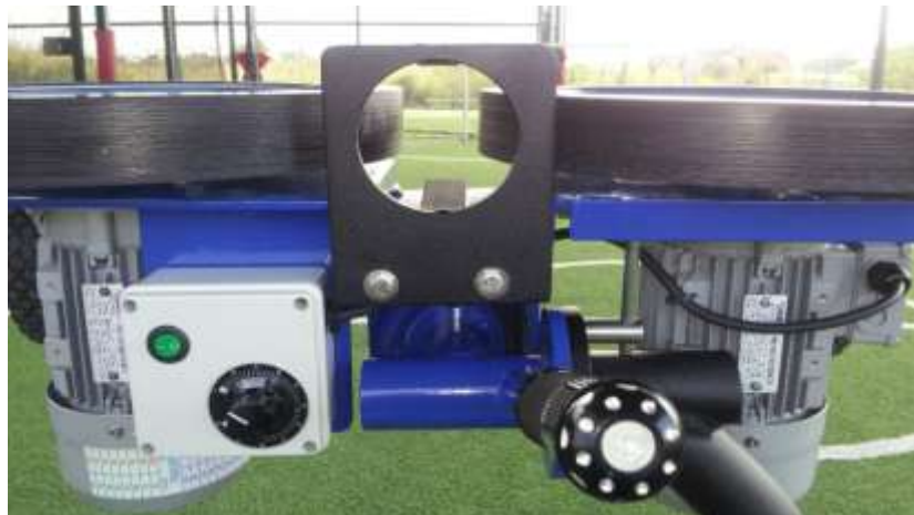
Figura 7.4. Configuración de dispositivo lanza pelotas, dos discos.
