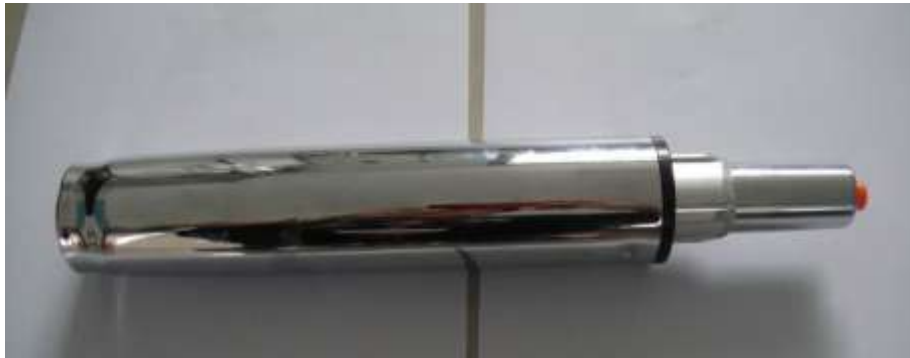
Figura 7.5. Configuración de dispositivo neumático, desplazamiento vertical.
