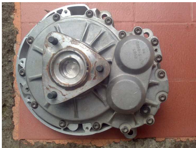
Figura 10. Motorreductor de un Segway.
