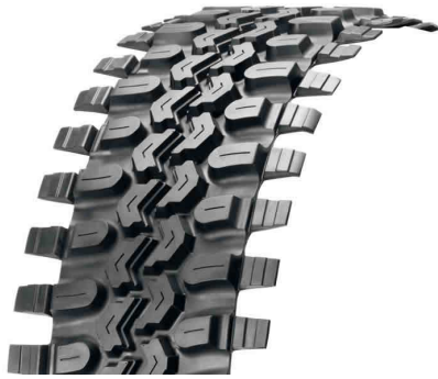
Figura 23. Banda precurada que se adicionara a los rines del robot Pakal [6].
