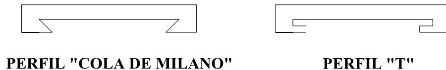
Fig. 30. Perfil “Cola de milano” elegido junto a perfil “T”.
