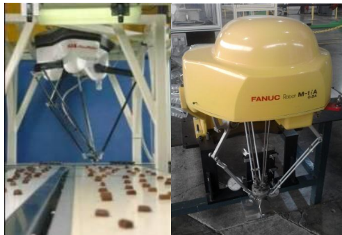
Figura 14. Robot delta en operación de procesado.
