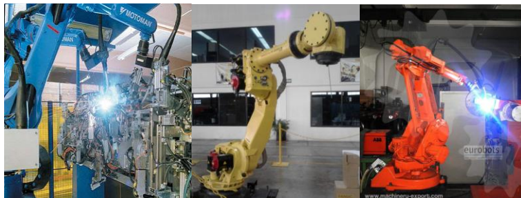
Figura 10. Robots utilizados en la aplicación de soldadura.
