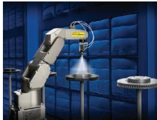
Figura 11. Robot recubriendo con pintura.
