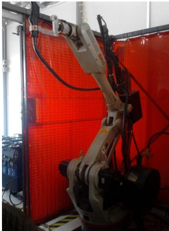
Figura 15. Robot de 6 GDL para corte con plasma.
