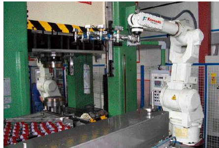
Figura 13. Robot en el proceso de alimentación de máquinas.
